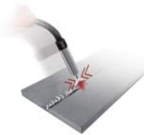
Drát připraven. Pomocí této speciální funkce řízeného hoření drátu (drát se nikdy nepřilepí) získáme perfektní přípravu pro další zapálení oblouku.
