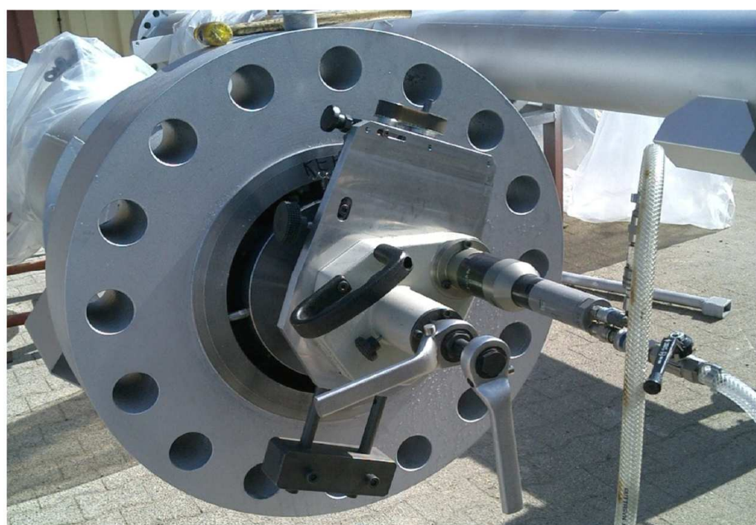
Opracování a oprava povrchu přírub
